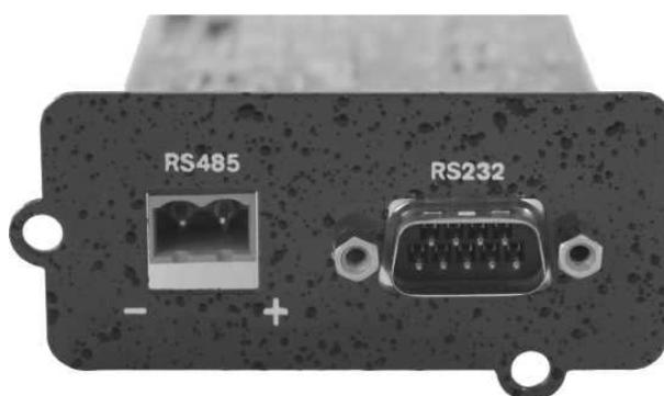
Рисунок 42 - Плата OC485CARD
